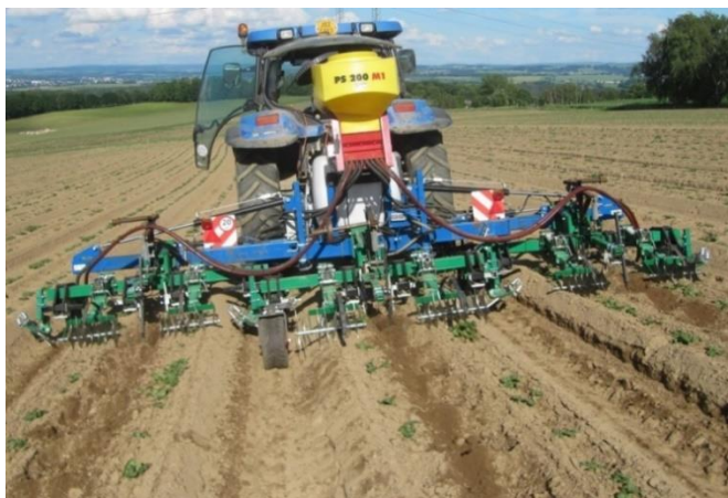
Obr. 11: Kypření hrůbků na začátku vzcházení brambor s obnovou důlků v brázdě, přihnojením a setím pšenice do kolejové brázdy
